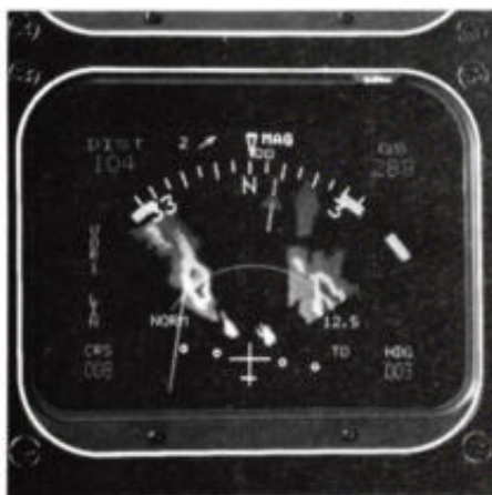
Afb. 2. Display van het centrale weergeefstelsysteem van Collins, dat zowel het weer als de koers weergeeft. De koers (CRS) wordt zowel analoog als digitaal gepresenteerd. De andere aanduidingen zijn HDG ('heading' of hellingshoek), DIST ('distance' of afstand) en GS ('ground speed' ofwel snelheid ten opzichte van het aardoppervlak).
