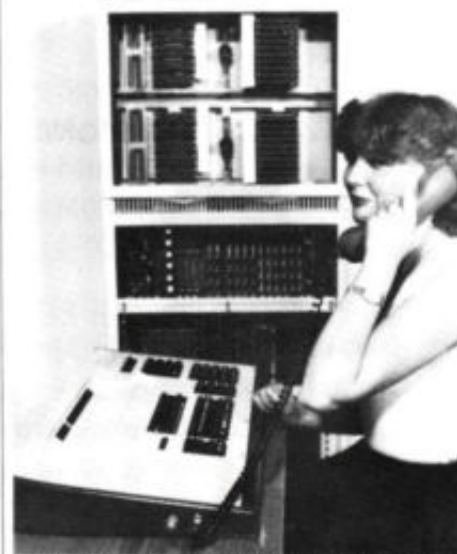
Afb. 7. Digitale subcentrale NZ400D, bestemd voor plaatsing in kleinere en middelgrote bedrijven en instellingen.
