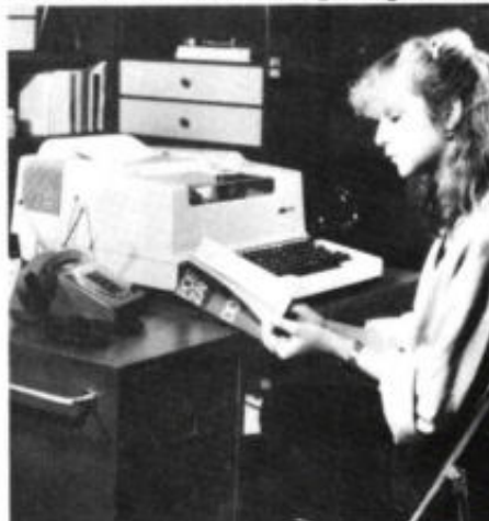
Afb. 9. Telexapparaat F2000. Enkele kenmerken van dit apparaat zijn een overdrachtssnelheid tot 200 baud, multiprocessorbesturing en een geheugen voor 99 verschillende teksten met in totaal 8000 tekens.
