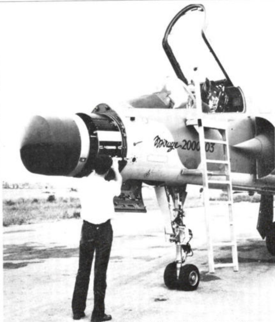
Afb. 3. Achter de neus van deze Mirage 2000 verschuilt zich de antenne van de multimodus-pulsdopplerradar van Thomson-CSF.
