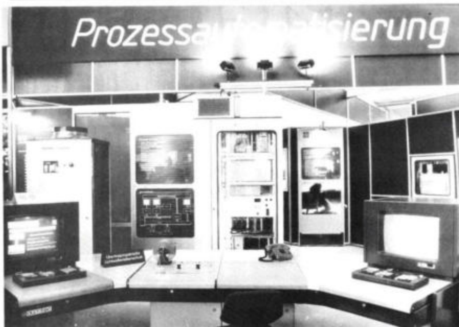
Afb. 5. Demonstratie-opstelling van een glasvezelverbinding in procesapparatuur voor een staalwalserij.
