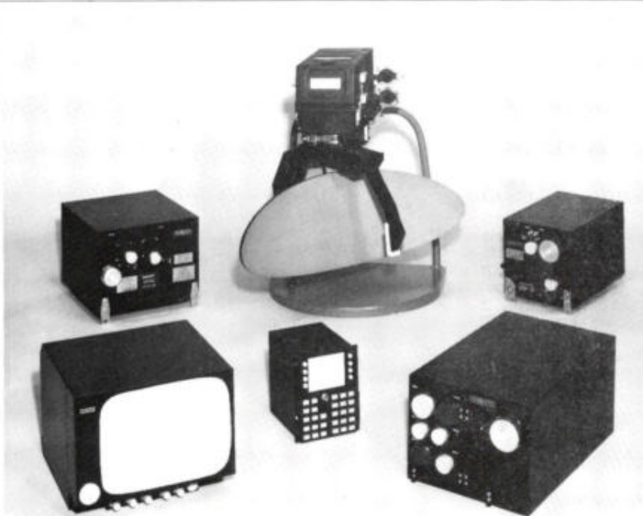
Afb. 1. De verschillende componenten van de „Seaspray“-radar type Mk3 van Ferranti, gebruikt voor detectie van snelle, kleine marinevaartuigen op zee vanuit een helicopter. De beweegbare antenneschotel (middenboven) bevindt zich onder de neus van de helicopter en 'kijkt' onder een horizontale hoek van 180 graden. Linksboven is de zender en rechtsboven de ontvanger weergegeven. Onder de ontvanger is de signaal-verwerkingseenheid te zien, middenonder het bedieningspaneel in de cockpit en links onder het display.
